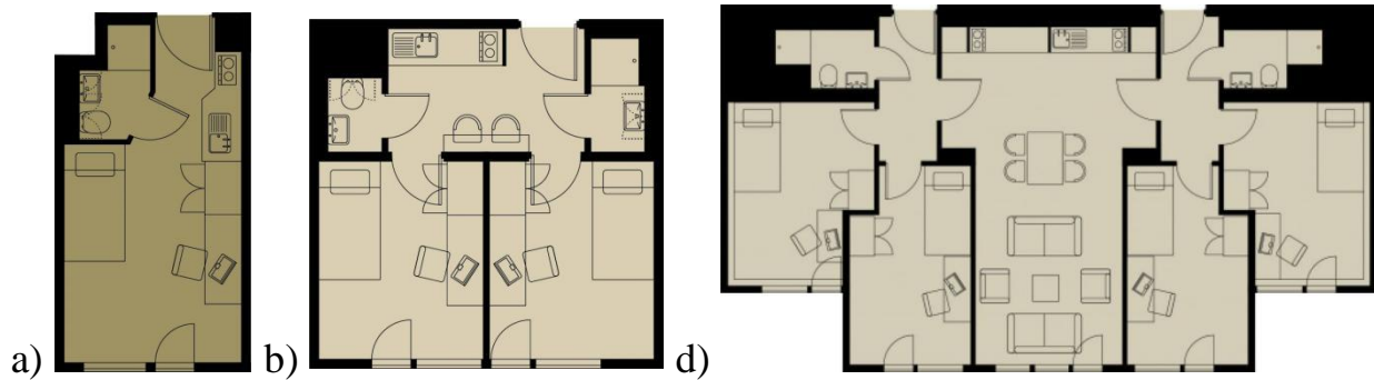
2-rasm. Yotoqxonalar tarhi. a) bronza kategoriyasidagi bir kishilik studio yotoqxonalar tarhi. b) ikki kishilik yotoq c) to‘rt kishilik yotoq
